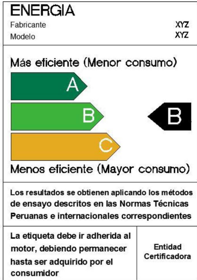
Figura I.1 – Diseño de la etiqueta de eficiencia energética para los motores eléctricos asíncronos o de inducción con rotor de jaula de ardilla
